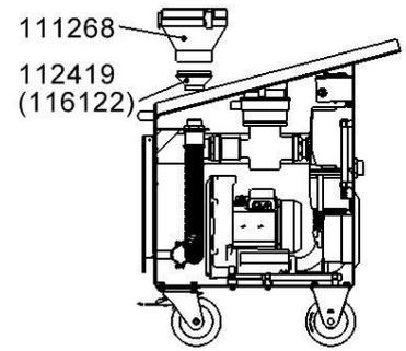
Filterung direkt am Gerät mit Saugschlauch
