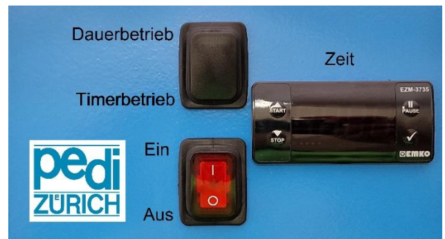
Schalter für Ein/Aus und Betriebsart sowie Timer
