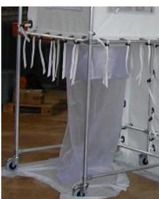
Der Ausschleussack besteht typischerweise aus weich-PVC in der Stärke 0.4 mm. Er ist transluzent und besitzt einen eingearbeiteten O-Ring zur Befestigung an einem Handschuhstutzen. Die Ausführung erlaubt einen kontaminationsfreien Sackwechsel. Der Schleussack wird passend zum gewählten Stutzen hergestellt. Die Länge der Säcke ist wählbar.
