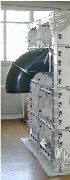
Mit dem Ausschleusbogen mit 45° oder 90° Winkel kann das zu entsorgende Gut zum Beispiel in ein Fass entsorgt werden.
